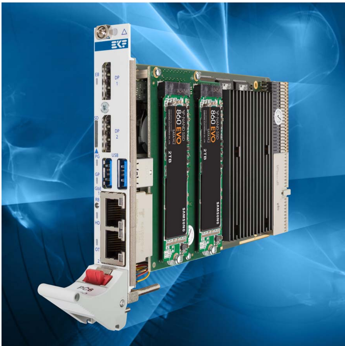
PC6-TANGO w. C48-M2 Low Profile SSD Module
